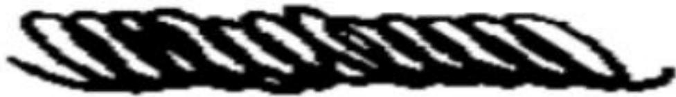
斜圈法运条焊接示意图
