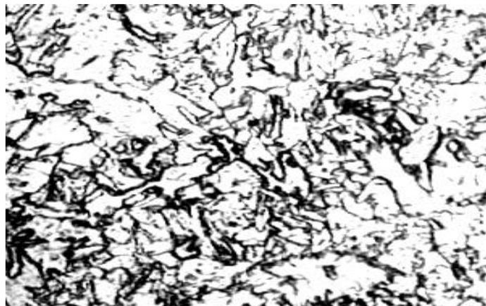
图 B610CF-L2钢板t/2处的金相组织
